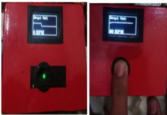
Gambar 3. Tampilan Alat Saat Tidak Mengukur (Kiri) & Saat Mengukur (Kanan)
