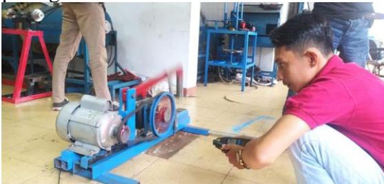
Gambar 6. Pengumpulan Data Kecepatan Dengan *Tachometer*
