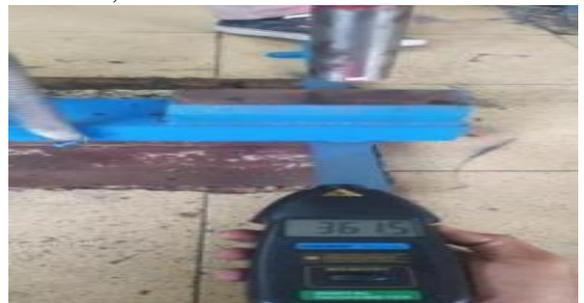
Gambar 9. Data Kecepatan *Hammer* Pada Saat Penempaan
