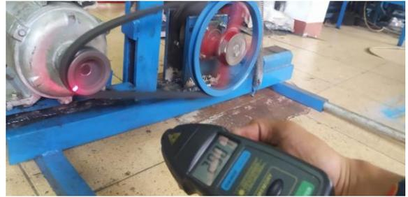
Gambar 7. Data Kecepatan *Pulley* Motor Penggerak
