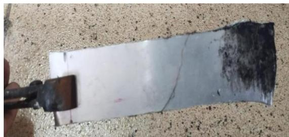
Gambar 15. Hasil Tempa Logam Aluminium Ketebalan 5mm
