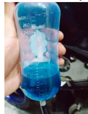
Gambar 7. Botol Ukur Bahan Bakar Setelah Berjalan 5 Km Dengan Kecepatan 70 Km/Jam
