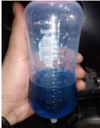
Gambar 3. Botol Ukur Bahan Bakar Setelah Berjalan 5 Km Dengan Kecepatan 30 Km/Jam
