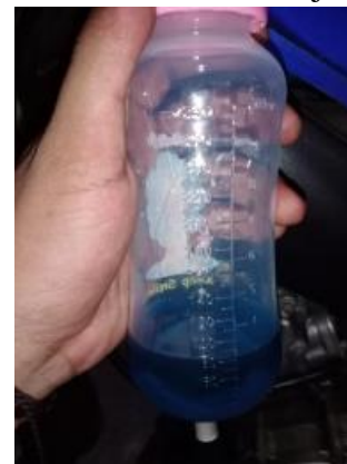
Gambar 11. Botol Ukur Bahan Bakar Setelah Berjalan 5 Km Dengan Kecepatan 50 Km/Jam
