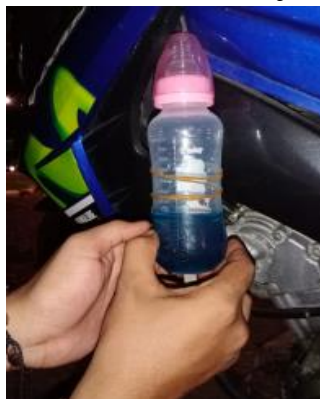
Gambar 9. Botol Ukur Bahan Bakar Setelah Berjalan 5 Km Dengan Kecepatan 30 Km/Jam
