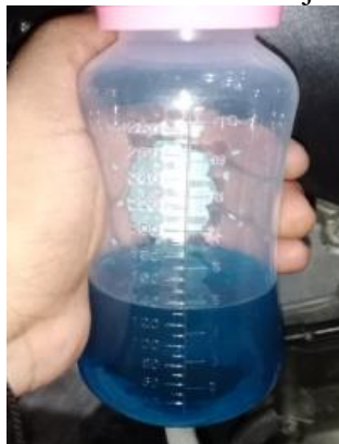
Gambar 15. Botol Ukur Bahan Bakar Setelah Melakukan Perjalanan Sejauh 2 Km Dengan Transmisi 1,2,3
