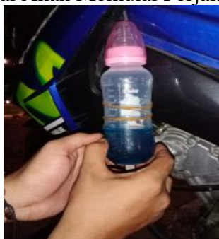
Gambar 5. Botol Ukur Bahan Bakar Setelah Berjalan 5 Km Dengan Kecepatan 50 Km/Jam
