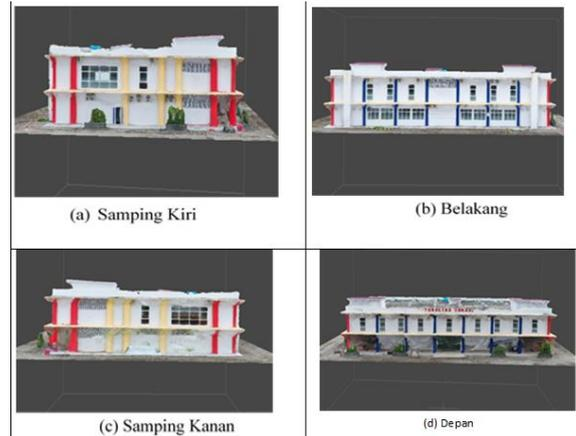
Gambar 8 Hasil mesh dan texture dari pengolahan dense cloud point Agisoft Photoscan (a)Samping Kiri, (b) Belakang, (c) Samping Kanan (Sumber : Pengolahan Data 2024)
